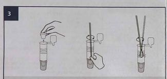
Nehmen Sie das Extraktionsröhrchen mit integriertem Puffer und entfernen Sie den weißen Deckel.
